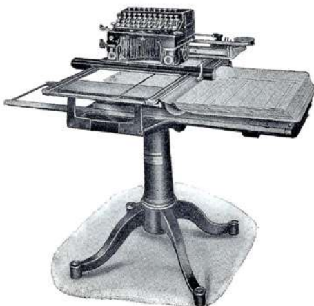
Fig. 11.15 Elliott-Fisher book typewriter. From R.G. ter Haak, Kantoormachines en administratieve systemen [...] (Amsterdam: H.J. Paris, 1927), p. 100.
